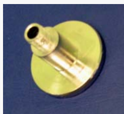
Держатель магнитов МН-01 для стыковки световода МС-01 с магнитными насадками
