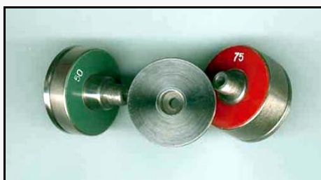
Магнитные насадки ЗМ 2 видов: 25мТл/50мТл, 50мТл/75мТл
