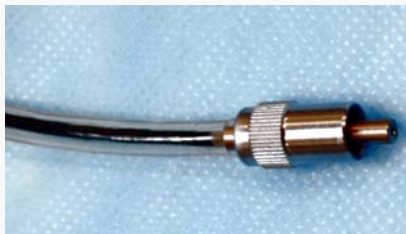
Магистральный световод МС-01 без адаптера (2,5 м)
