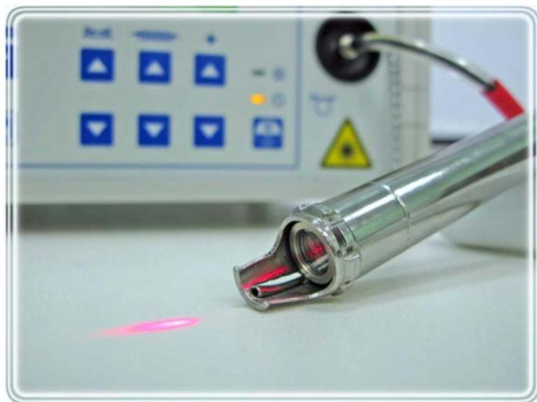
Новая технология диодных лазеров в сочетании с фокусирующей насадкой обеспечивает оптимальную геометрию луча для лечения сосудов. Относительно плоский «купол» и отвесно спадающие фронты пучка обеспечивают почти гомогенное распределение энергии по всему поперечному сечению пучка. Благодаря этому отсутствуют пики энергии, и происходит равномерная окклюзия сосудов.
